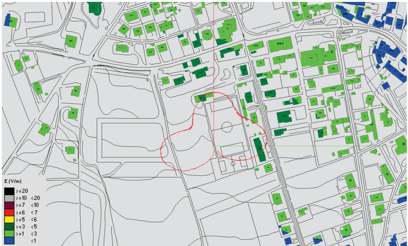
Fig. 13 Impatto Elettromagnetico – zona Via Schiratti Ip2 – Vista dall'alto senza solido
